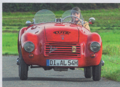
Dieser Barchetta ist ein Unikat mit einer Karosserie aus Aluminium von einer Flugzeugtragfläche
