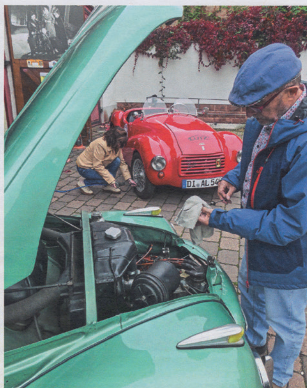
Fahrzeugcheck vor unserer Ausfahrt auf den Otzberg. Der Kühler des Topolino sitzt übrigens hinter dem Motor!
