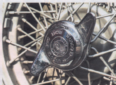
Statt Borrani sind Drahtspeichenräder von Rudge-Withworth montiert
